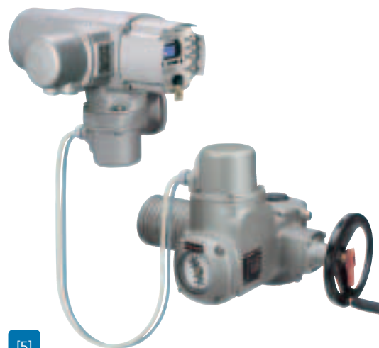
[5] Многооборотные приводы со средствами управления на настенном креплении Средства управления могут быть смонтированы на настенное крепление отдельно от привода. Это рекомендуется в случае если: ■ Невозможно смонтировать средства управления непосредственно на привод из-за ограниченности пространства, ■ Высокая температура окружающей среды способна повредить электронные элементы привода, ■ Интенсивная вибрация клапана может оказать влияние на средства управления.
